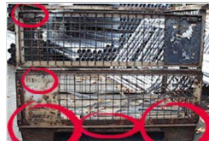
Mögliche Verunreinigung der Ladegüter durch hohen Rost-/Verschmutzungsgrad
