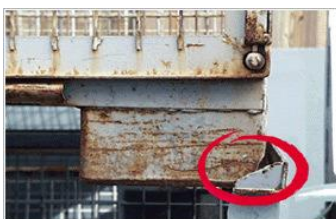
Verbogene Bodenrahmen oder FüÙe
